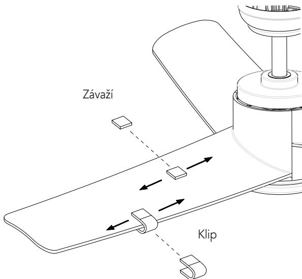
Zapněte ventilátor a nastavte rychlosť (obvykle vysokou), která způsobuje nejhorší kmitání.
